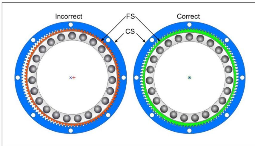
Bei der Montage des Getriebes ist darauf zu achten, dass der FS mittig im CS sitzt. Es kann passieren, dass der FS auf einer Seite einen Zahn überspringt.
